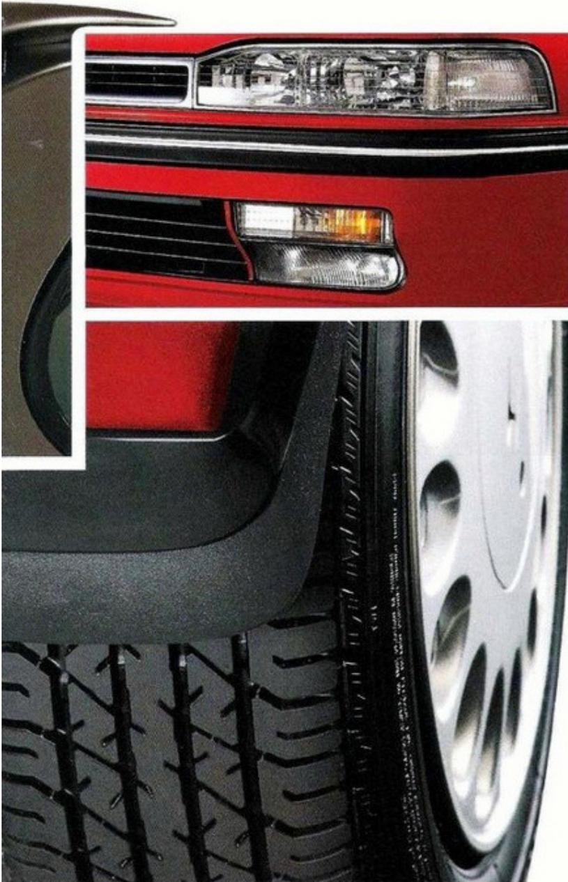
Nebelscheinwerfer für paßgenauen Einbau im unteren Stoßfängerteil.
