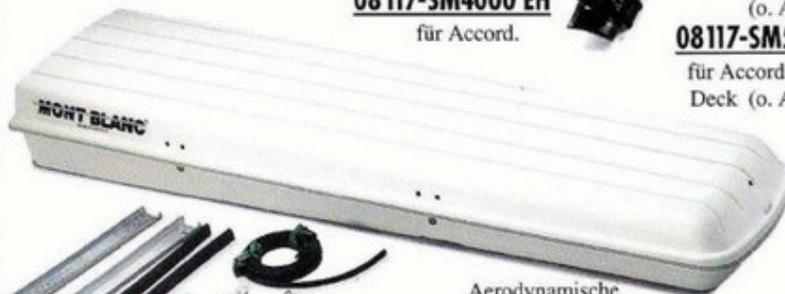
Aerodynamische Ski-Box für vier bis fünf Paar Ski bis 2,15 m oder sperrige Güter. Sicherung durch zwei Druckzylinderschlösser. Für alle Accord.
