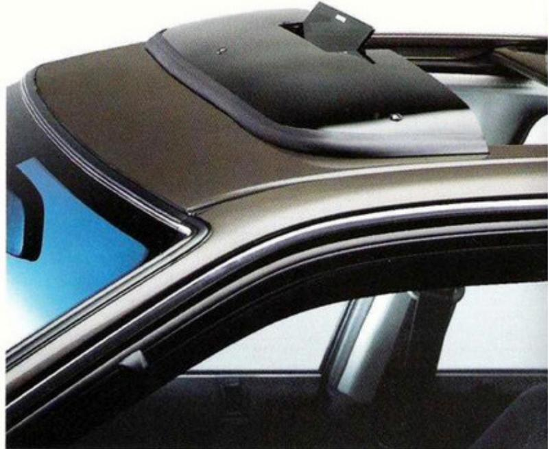
Aerodynamikteile aus PU-RIM-Material.
